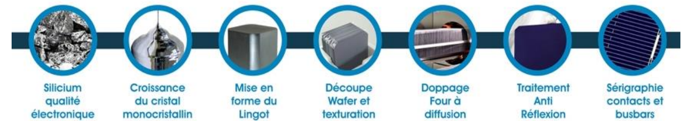
Figure 25 : Procédés de fabrication d'une cellule cristalline semi-conductrice de silicium (Jade Technologie, s.d.)
